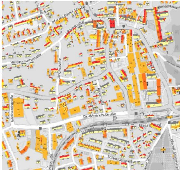
Abbildung 17: Beispielhafte Darstellung der mittleren Jahresglobalstrahlung auf Dachflächen des 3D-Gebäudemodells (LoD2) der Bayerischen Vermessungsverwaltung (Dunkelrot: Gering, Gelb: Hoch)
